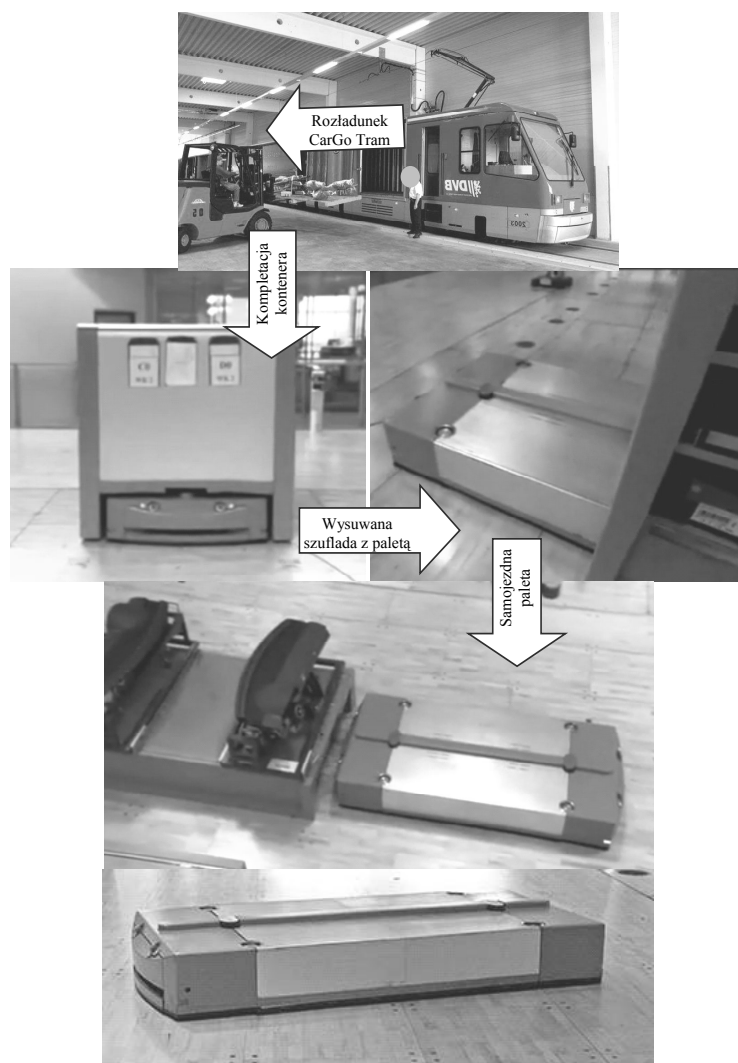
Rys. 3. Zintegrowana technologia przepływu części do linii produkcyjnej (samojezdne automatyczne i bezobsługowe kontenery i palety)
