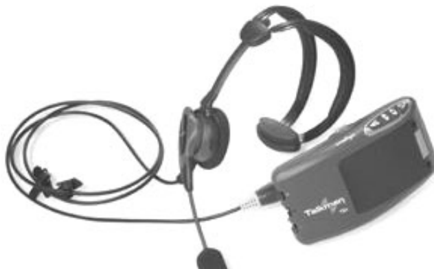
Rys. 12. Talkman T2x Voice Terminal – element głosowego systemu komunikacji
