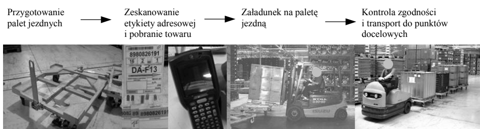
Rys. 14. Schemat procesu wydania dużego asortymentu z magazynu produkcyjnego z wizualizacją stosowanych urządzeń
