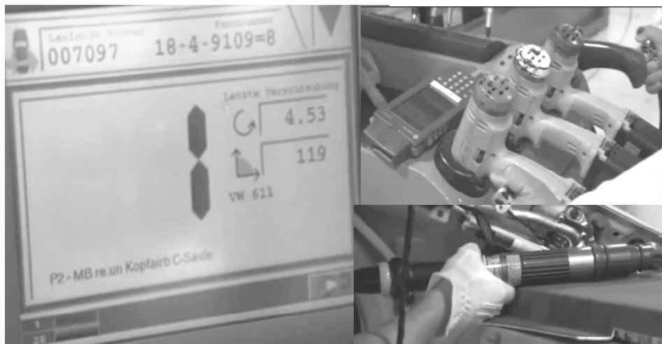
Rys. 4. Zintegrowane narzędzie montażowe i widok ekranu monitorującego
