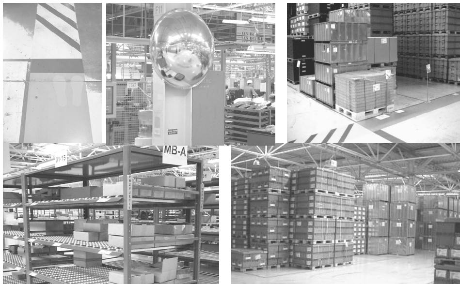
Rys. 2. Elementy infrastruktury korytarzy transportowych (u góry) oraz lokalizacja regałów małego asortymentu (regały grawitacyjne) i dużego asortymentu (palety) (na dole)
